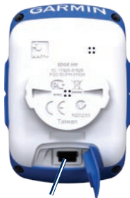
Porta mini-USB sotto il cappuccio protettivo
