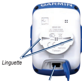
Linguette Porta mini-USB sotto il cappuccio protettivo
